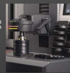
使用**»toolBalancer«校正刀具平衡** 您需要精调刀具的平衡才能确保CNC机器能够高效流畅地工作。通过 ZOLLER开发和制造的»toolBalancer«平衡系统来校正刀具平衡,其成效 远不止于出色的精度。
