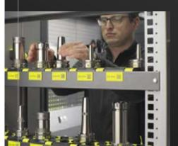
配工作提供便利的环境。通过背面安装的操作单元或独立式操作单元 接控制ZOLLER »keeper«刀具柜,可选取和提取Tooling Solutions刀柄或 整套刀具等物品,还可通过3D图像显示存储位置、图纸和零件清单。
