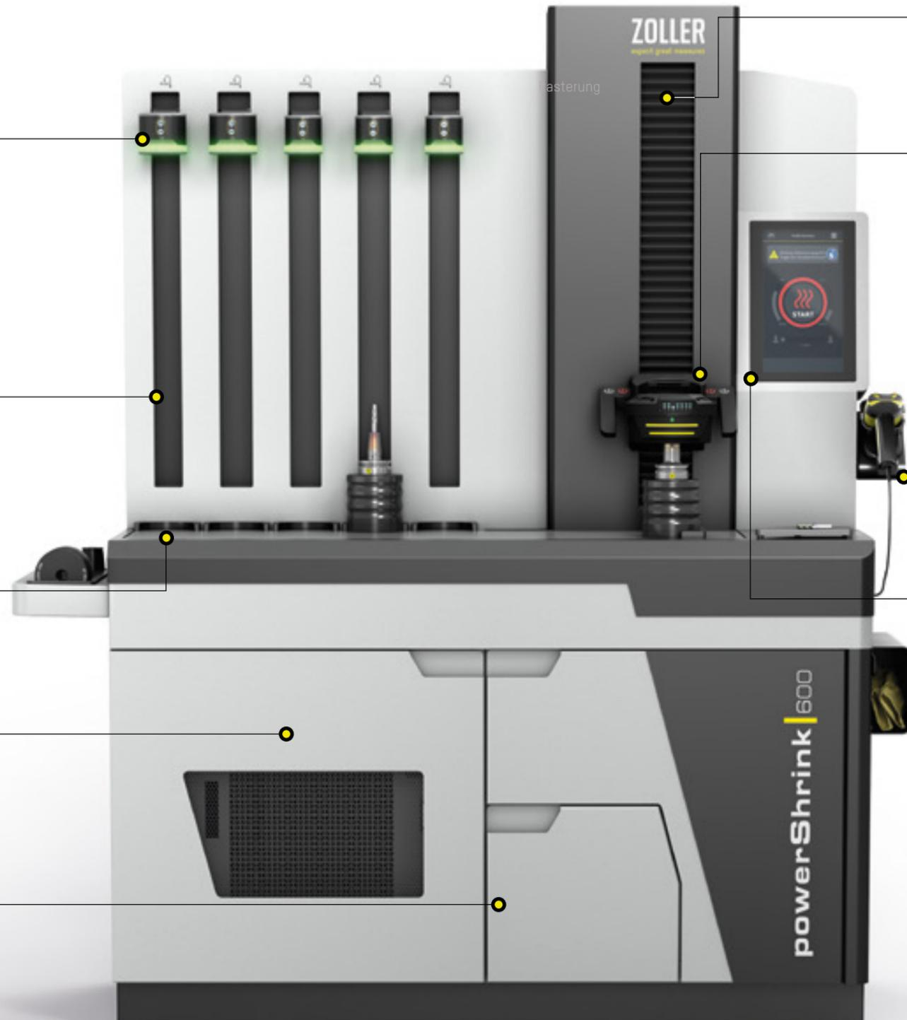
**Leichtgängige Spulenachse** – für eine schnelle und komfortable Bewegung der Spule. Das pneumatische Lösen der Achsklemmung, die hochgenaue THK-Linearführung und das Gegengewicht ermöglichen der Bedienerin und dem Bediener ergonomische Arbeitsabläufe und eine lange Nutzungsdauer. Die maximale Werkzeuglänge beträgt 600 mm.
