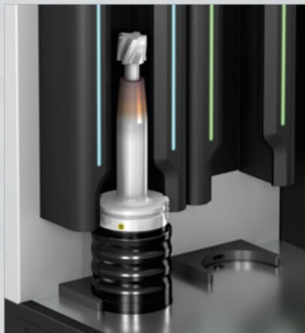
**Zwei bzw. drei separate Kühlplätze\*** für eine parallele, effektive Nutzung. Die Luftkühlung »zStream« eignet sich außerdem hervorragend auch zur Kühlung abgesetzter Werkzeuge.
