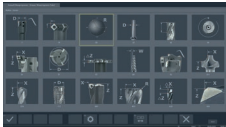
Une sélection complète de programmes de mesure dans »pilot 4.0« avec la boîte de dialogue de saisie photoréelle pour une utilisation facile et une indication sûre de la cote de consigne.
