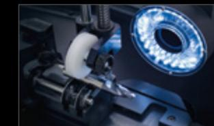
O dispositivo de inspeção **»pomBasic«** verifica as ferramentas até 70 parâmetros de ferramenta numa questão de segundos. Inserir, aproximar, medir.
