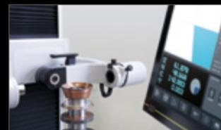
Medição do pacote de mós abrasivos com o aparelho de medição da ZOLLER permite obter dados precisos e armazenados centralmente para o processo subsequente.
