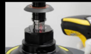
A **identificação** das ferramentas medidas e dos mós medidos com **»zidCode«** inicia a transferência automática de dados para a máquina de retificação.
